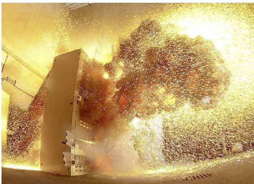
Störlichtbogenprüfung ohne Schutzmassnahmen.
